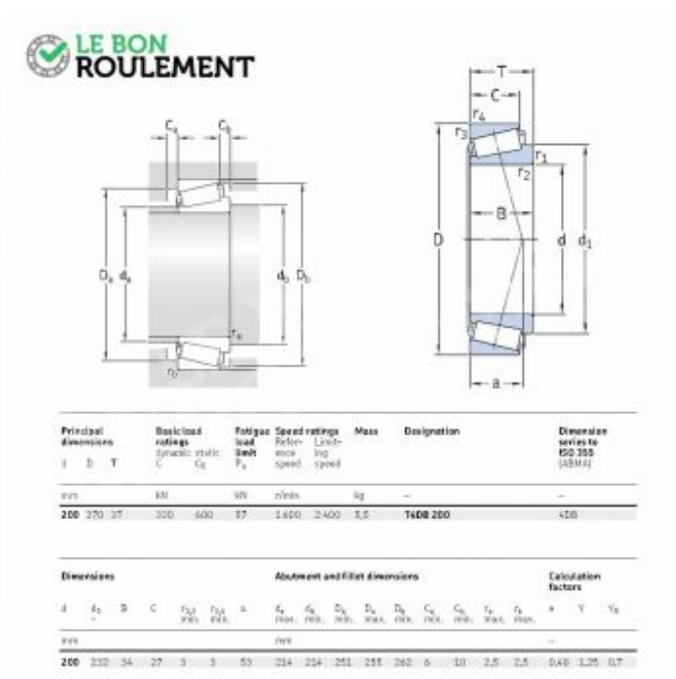
**Rodamiento de rodillos cónicos T4DB200-SKF**
