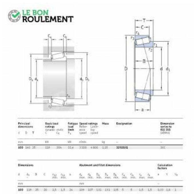
**Rodamiento de rodillos cónicos 32920/Q-SKF**
